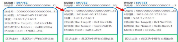
图 1 区块链工作原理示意图
